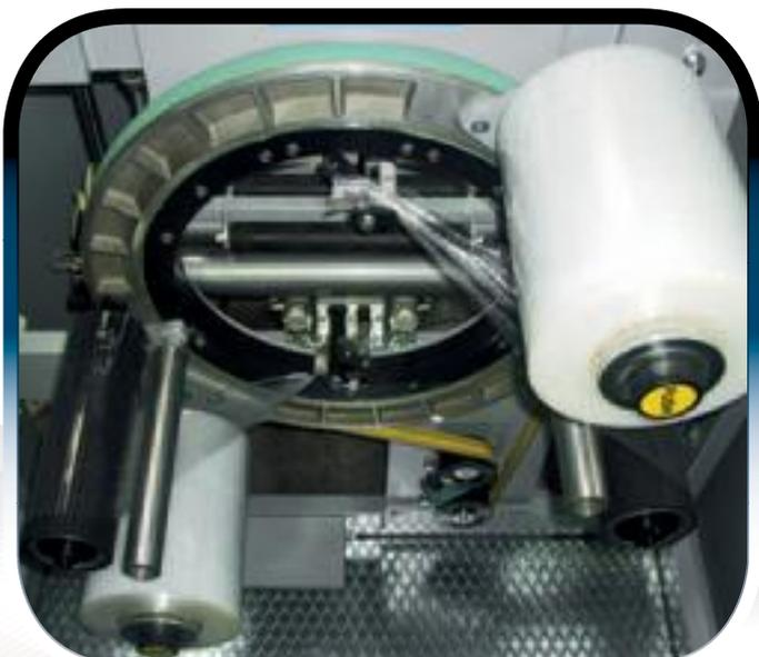
Le Spiror DR sono macchine ad anello a doppia bobina. Tale caratteristica permette di raggiungere prestazioni estremamente elevate di avvolgimento con film estensibile e porta la gamma SPIROR a livelli di eccellenza assoluta. La presenza di due gruppi portabobina consente, infatti, velocità d'imballaggio altissime ed una capacità produttiva (pezzi/min.) quasi doppia.
